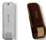
**Sensore via radio a tenda ; Sensore da esterno doppia tecnologia a tenda via radio** per ricevitore Art.100012; **Frequenza 868 MHz**; Copertura 7,5° portata 12 mt; Fornito con batteria al litio; Ingresso per contatto N.C. o veloce; Autonomia 3 anni; Colore bianco (Art.160003) o Marrone (Art.160003M)
