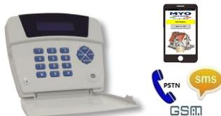
**Avvisatore telefonico PSTN/GSM ;** Avvisatore ibrido per GSM e PSTN a **4 canali;** Display: retroilluminato; Invio di messaggi vocali e SMS; Ingressi allarme a dare: 1 e 2 positivi, ingressi 3 e 4 negativi; 3 Uscite: open collector; Messaggio vocale: registrabile da 20"; **Gestione remota delle uscite anche con APP gratuita MYOSMS;** Funzione Open Gate; **Menù in italiano;** Dimensioni: 165(B) x 140(H) x 37(P) mm.
