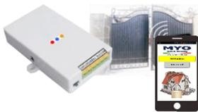
**Controllo remoto GSM ;** Modulo GSM incorporato quadri band; **99 utenti memorizzabili;** Invio messaggio SMS di conferma su commutazione bistabile; **Attivazione a costo zero** per la commutazione monostabile; Applicazioni: commutazione carichi elettrici remoti (riscaldamento o condizionamento, pompe) apricancello, aprigarage; Contatto relè 30V -2A; Alimentazione: 12/24 VDC. **Gestione remota da smart phone con APP gratuita MYOSMS.** Dimensioni: 100 x 53 x 27 mm.
