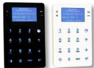
**Tastiera SLIM LCD Touch screen ;** Tastiera di controllo Touch screen capacitiva per centrali OR con retroilluminazione azzurra; Permette anche di effettuare una parte di programmazione; Collegamento sul bus RS485 a 4 fili; Colore chiaro Art.100044 (colore Nero Art.100044N); Dimensioni: 141 x 87 x 18 mm.
